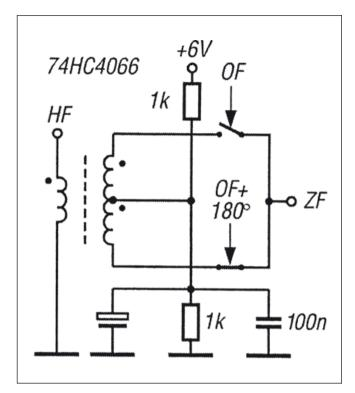
Bild 4.27: Balancemischer mit HCMOS-Schalter-IC
