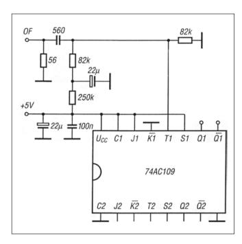
Bild 4.33: Oszillatorspannungs-Aufbereitung für doppelte Eingangsfrequenz
