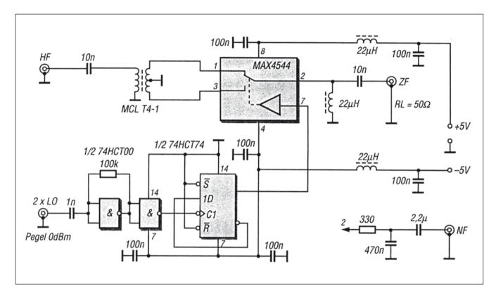
Bild 4.36: Einfacher Doppel-Balancemischer mit Umschalter-IC MAX 4544
