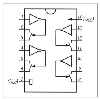
Bild 4.29: Innenaufbau des schnellen Schalter-ICs FST 3125M
