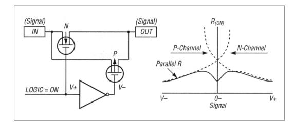
Bild 4.32: Der Ein-Widerstand eines CMOS-Schalters ergibt sich aus der Parallelschaltung der Kanalwiderstände, die stark von der Signalspannung abhängig sind.
