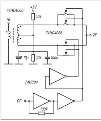
Bild 4.28: Praktisch günstige Parallelschaltung zweier Schalter
