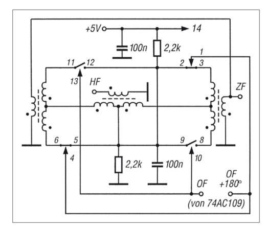
Bild 4.30: Doppel-Balancemischer mit FST 3125M und drei identischen Transformatoren (z.B. je 3x6 Wdg. 0,4-mm-CuL-Draht auf Ferritringkern)
