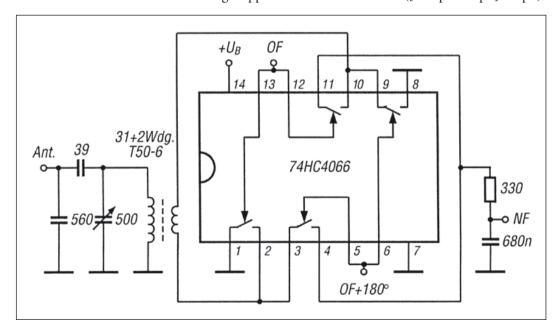
Bild 4.31: Frontend des Direktmischers "Pottenstein-RX" für 3,5, 7 und 10 MHz
