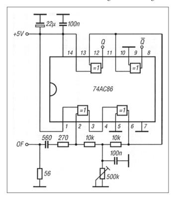
Bild 4.34: Oszillatorspannungs-Aufbereitung ohne Frequenzteilung
