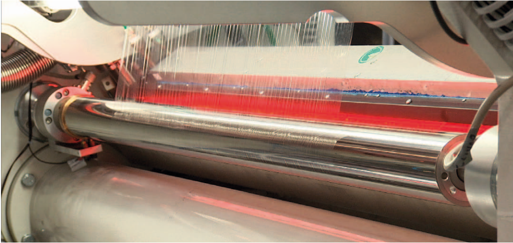
Bild 4: Eingespannt zwischen Sensor und Lichtquelle überprüft der Tichawa CIS die Folie auf Risse, Löcher, Einschlüsse oder Dünnstellen
