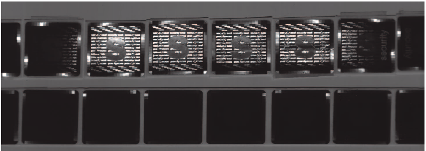
Bild 2: Hologrammstreifen, abgebildet mit einem Zeilenkamerasystem. Hier kommt es zu Verzerrungen, verursacht durch sich ändernde Blickwinkel der Linse
