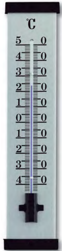
INDOOR/OUTDOOR THERMOMETER aluminium, eloxed, weather resistant, with fixing material THERMOMETRE INTERIEUR/EXTERIEUR aluminium, anodisé, résistant aux intempéries, avec matériel pour l'assemblage
