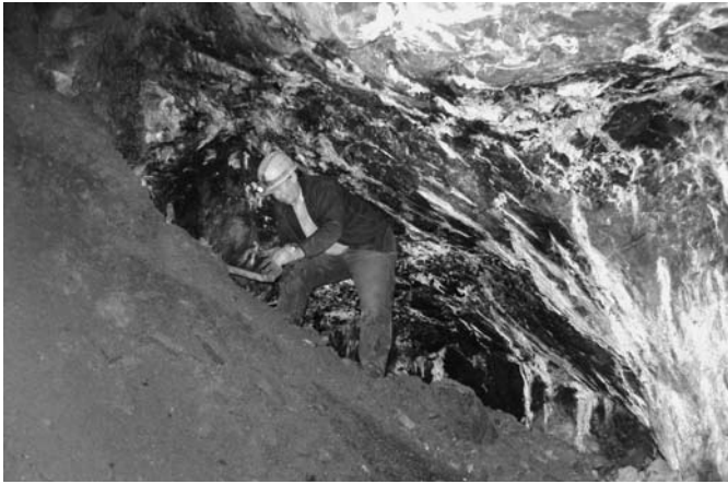
Schutthaufen auf dem Niveau des Dalvazzerstollens mit Erzabbaustelle, die in der ersten Periode durch Feuersetzen entstanden ist.
