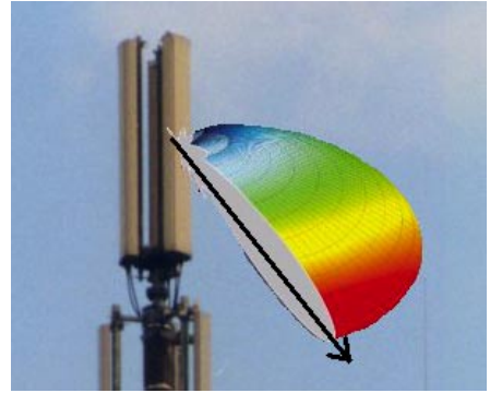
Bild: Antennen einer Basisstation mit Darstellung der typischen Abstrahlcharakteristik und der Hauptstrahlrichtung in Schnittdarstellung
