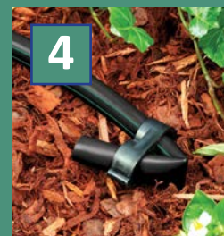
4 滴灌管末端數字 8 狀可以兼作沖洗閥
