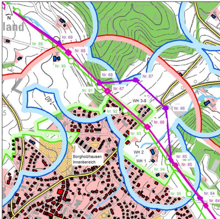
Abbildung 5: Trassenalternative Goldbreite (Bestandsleitung in Grün, geplante Freileitung in Magenta, Variante „Goldbreite“ in Lila)
