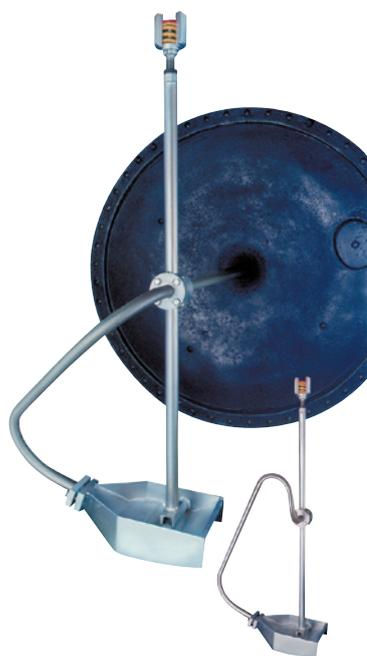
Für niedrige Geschwindigkeiten (kaskadierendes Kondensat) ist ein 180°-Vertikalrohr erhältlich. Es arbeitet als „Falle“, um die Schlupfdampfmenge zu minimieren, während der Kondensataufnahmeschuh außerhalb des Kondensat-Sumpfes rotiert.
