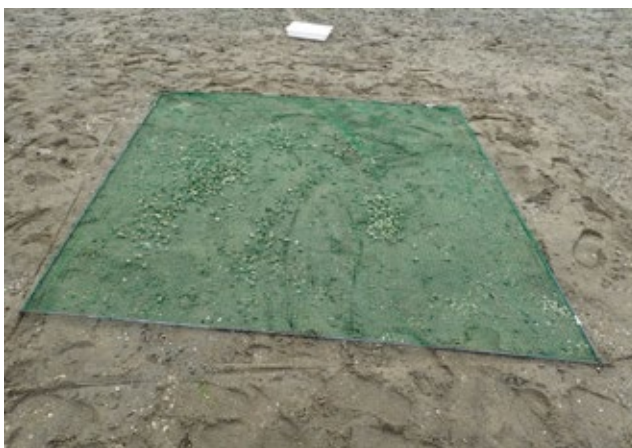
図1 網の縁に鉄筋を取り付けた網（鉄筋網）
