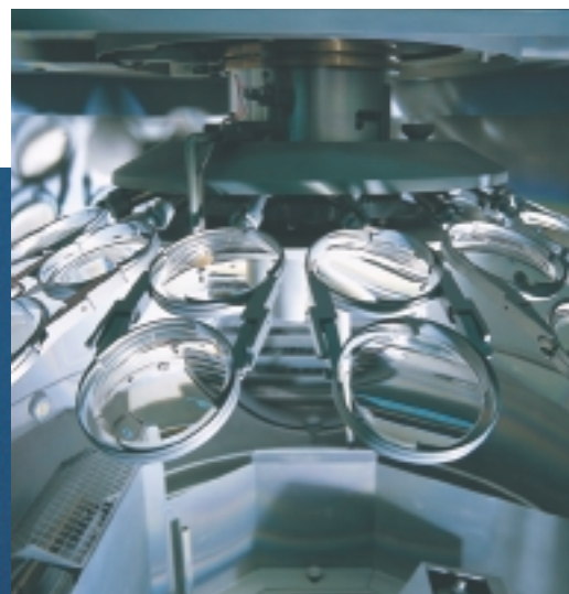
Traitement sous vide
