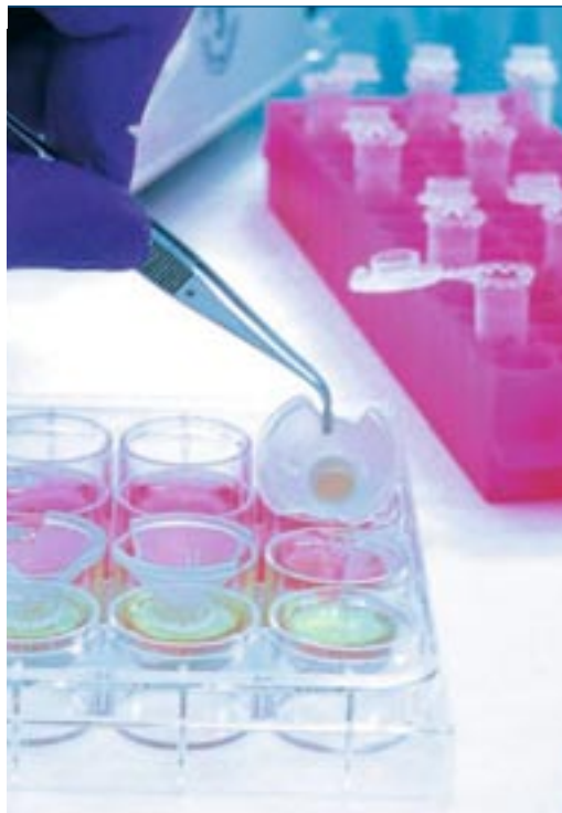
SkinEthic commercialise des kits de tissus reconstruits pour tester la sécurité des produits.
