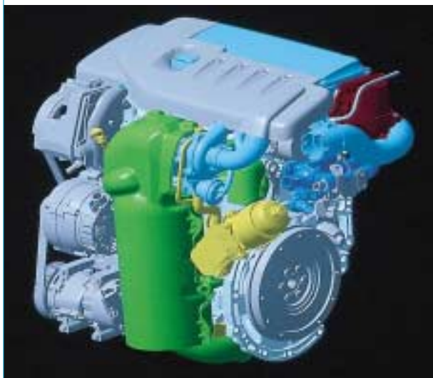
Nouveau moteur common rail HDI 1,4l
