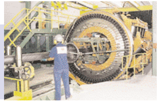
Fabrication de conduites flexibles à l'usine CSO de Vitoria
