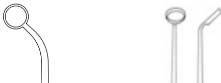
45° vertikal aufwärts ge- winkelt, beidseitig arbeitend 45° vertical angled up, working on both sides
