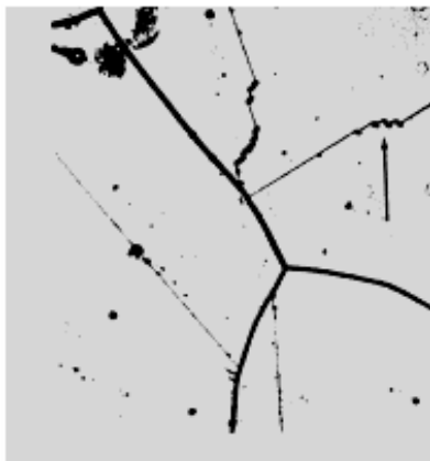
11. ábra: Kristályközi korrózió
