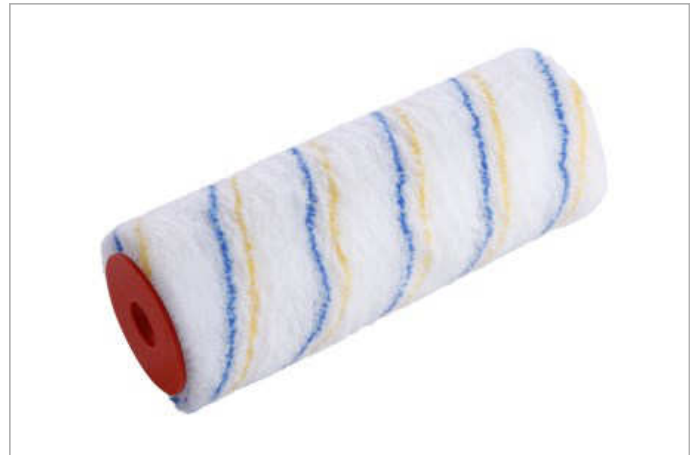
Malerwalze "Nylon blau/gelb", ungepolstert 58 cm Rollendurchmesser. 100 % Polyamid, geeignet für Dispersions-, Latex- und Silikatfarben auf glatten bis leicht rauen Untergründen
