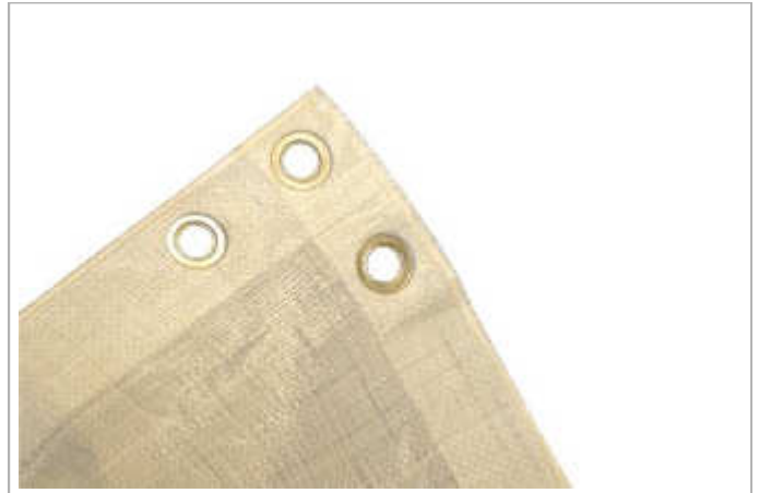
PE-Doppelösengerüstschutzplane, weiß/transparent Bändchengewebe 12x12 Fäden/inch 2 ; laminiert auf beiden Seiten; Geschweißter, verstärkter Saum; je zwei Alu-Ösen in 0,5 m-Abständen Nr. 5160170 - 3,1m x 10 m
