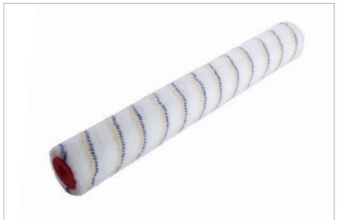
Bodenwalze "Nylon gelb/schwarz", ungepolstert 100 % Polyamid, Florhöhe 13 mm, geeignet für Versiegelungen, Öl-, Lack- und Kunstharzfarben sowie Rostschutzanstriche Nr. 5170245 50 cm Nr. 5170280 Bügel für Bodenwalzen, ausziehbar 40-60 cm
