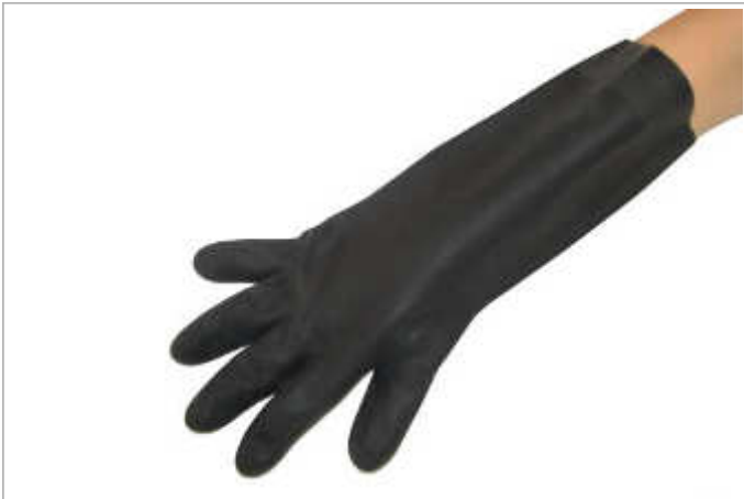
Neopren-Handschuh, lang 38 cm innen mit Baumwolle beschichtet, beständig gegen viele Säuren und Laugen, Dicke 0,7 mm, Länge 38 cm
