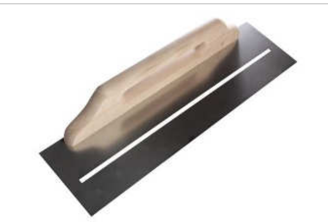
Fugen Top, rostfrei mit Buchenholzgriff natur perfekte Verfughilfe für Spachtelarbeiten an allen Gipskartonplatten Nr. 936186 480 x 130 x 0,7 mm
