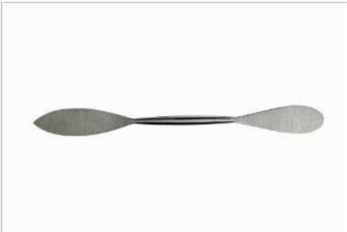
Stuckeisen 24 mm spitz / rund 24 mm aus Stahl geschmiedet und fein geschliffen Nr. 936207 250 mm
