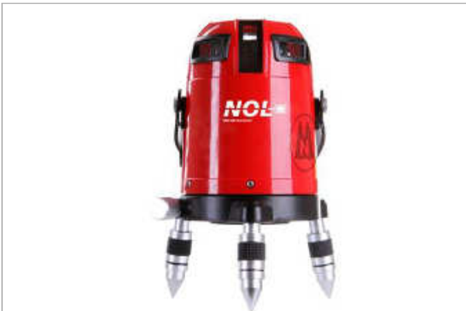
NESTLE Octoliner Linienlaser mit 360° Horizontallinie, 4 Vertikallinien, Lotpunkt unten. IP54, \pm 1,5\text{mm} auf 10m, Reichweite 30m Nr. 5177660
