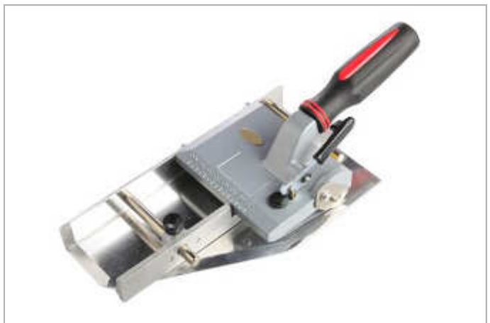
Teppichstreifenschneider, schwere Ausführung zum Schneiden von Sockelleisten, stufenlos einstellbar von 40-100 mm, inkl. 1x10er Pack Klingen 5173900 Nr. 5172793 Nr. 5173900 - Ersatzklingen 3-Loch extra stark 10er Pack
