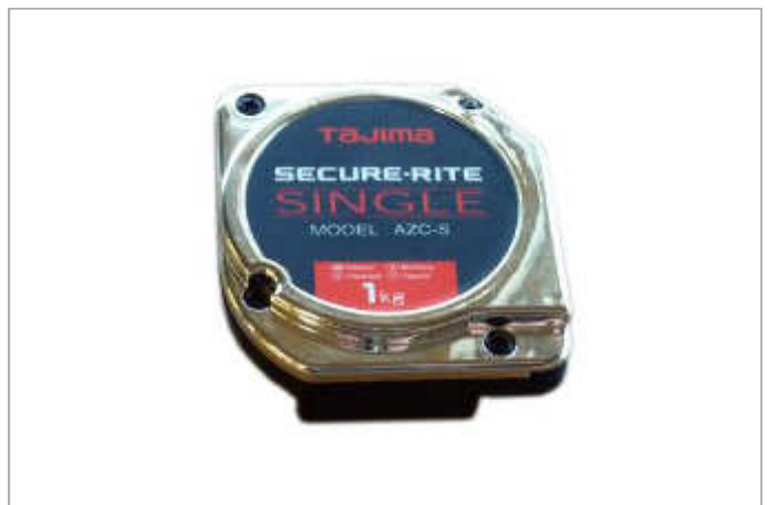
Tajima Sicherungsgerät für Handwerkzeuge kleine Werkzeuge bis 1 kg Gewicht werden festgehalten und können über 1 Meter ausgezogen werden
