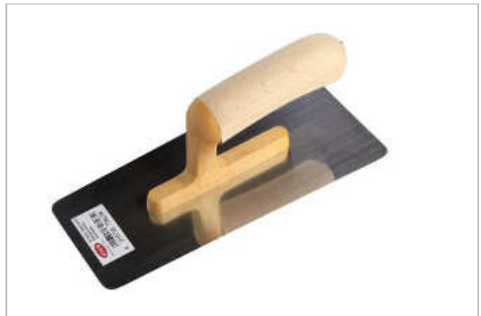
Venezianische Glanzputz-Glättekelle, rostfrei abgerundete und angefaste Kanten, Blatt aus gehärtetem, Spezial- Chromstahl, abriebfrei, Holzgriff mit Kunststoffstütze, geeignet für Glanz u. a. Marmorputze
