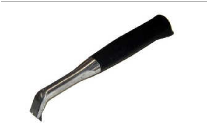
Farbschaber, Dreikantklinge mit 2-seitig angeschliffener Hartmetallklinge, Leichtmetallhalter, Softgriff Kunststoffhohlgriff, mit Gewinde zur Aufnahme von Alu-Verlängerung Nr. 5173090 25 mm - Dreikantklinge Nr. 5173050 40-63 cm - Alu-Verlängerung ausziehbar
