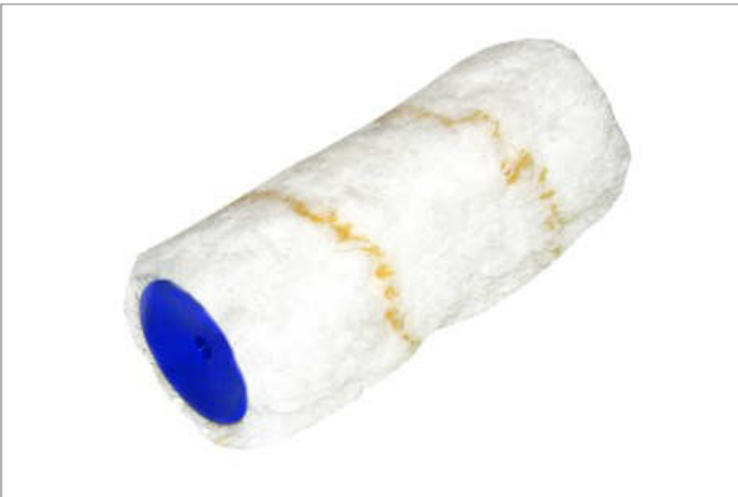
Malerwalze "Goldfaden", ungepolstert 100 % Polyamid, Florhöhe 18 mm universell einsetzbar für Wand-, Decken- und Fassadenfarbe, ebenfalls geeignet für Öl-, Lack- und Kunstharzfarben
