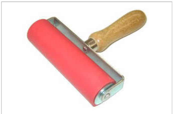
Andrückrolle aus Hartgummi 45 mm Walzendurchmesser, Doppelbügel aus Stahl, geeignet zum zum Andrücken schwerer Tapeten, sowie Folien in der Schildermalerei Nr. 5173845 50 mm Nr. 5173855 100 mm Nr. 5172789 150 mm
