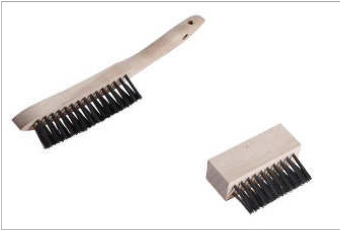
Kehlrahtbürste 3 Reihen, Stahldraht 0,35 mm Holzgriff, Stahldraht nach vorne V-förmig zulaufend. Zum Säubern von Fugen und Kanten. Nr. 936537 3-reihig
