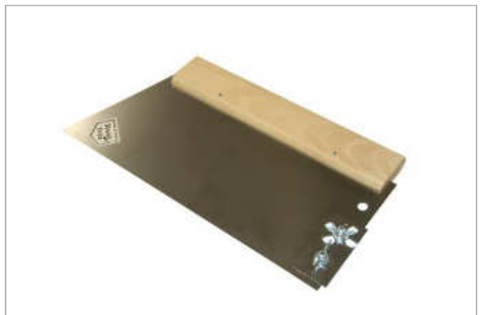
Höhenausgleichsspachtel zum Anspachteln von Höhenunterschieden, Anschlag verstellbar von 2-15 mm Nr. 908635 - 280 mm
