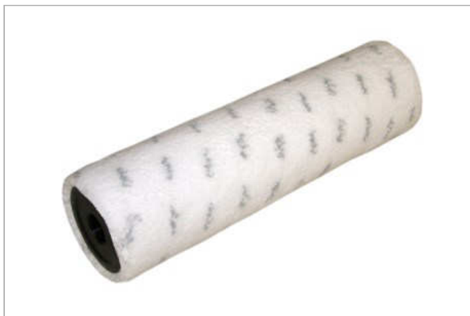
Exquisit-Farbwalze „Microstreif“, ungepolstert Mikrofaser, Florhöhe 9 mm, speziell für dünnflüssige Materialien, wie z. B. Lasuren, Beizen und Grundierungen. Extrem saugfähig. Auch geeignet für Dispersionsfarben im Innen- und Außenbereich Nr. 5179165 18 cm Nr. 5179170 25 cm
