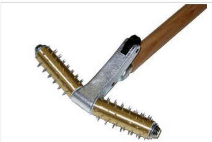
Tapetenkiller, Messingkörper V-förmig zueinander stehende Stachelwalzen bewirken eine wesentlich intensivere und schnellere Perforation der Tapete. Mit Holzstiel 50 cm. Nr. 936390 - 180 mm
