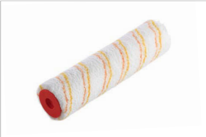
Lackierwalze "Microfiber gestreift", ungepolstert Florhöhe 10 mm, 48 cm Rollendurchmesser. Speziell für dünnflüssige Materialien wie z. B. Grundierungen, Beizen, Lasuren oder Latexfarben. Nr. 5179830 20 cm Nr. 5179835 25 cm
