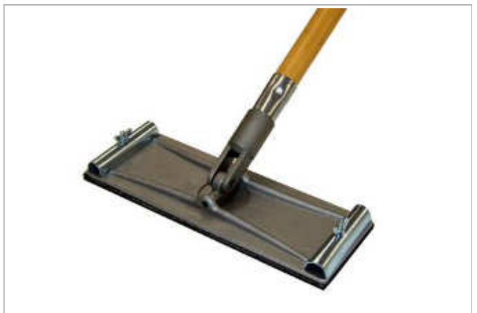
Stielschleifer, komplett mit Holz-Verlängerung mit Grundplatte aus Leichtmetall, aufgeklebter, 5 mm starker Zell- kautschuk-Platte, Klemmbacken Kardangelen aus Stahl, mit „female“- Adapter. 120 cm langer Holzstiel. Nr. 5173120 240 x 85 mm
