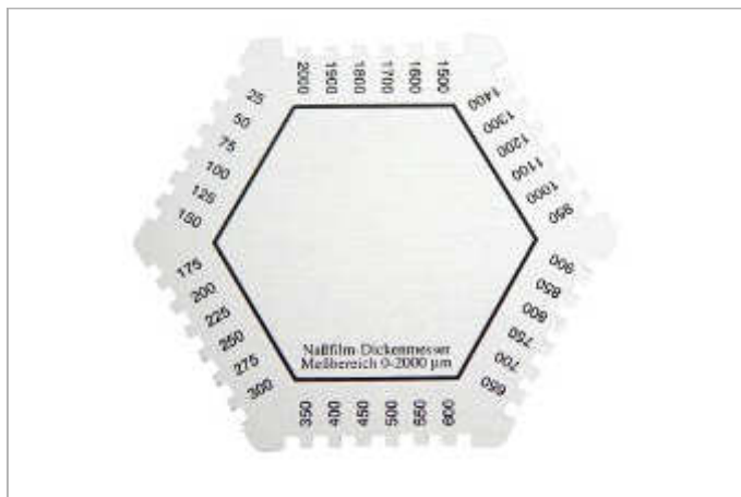
Nassfilm Schichtdickenmesser aus Aluminium, 6-eckig Messbereich von 25-2000 um, Bestimmung der Schichtdicke frisch aufgetragener Anstriche und Beschichtungen im nassen Zustand
