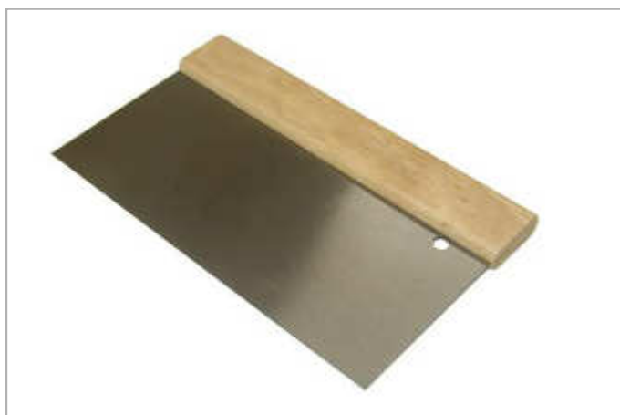
Türensapachtel aus 0,4 mm starkem, gehärtetem und poliertem Federbandstahl, 105 mm sichtbare Blatthöhe
