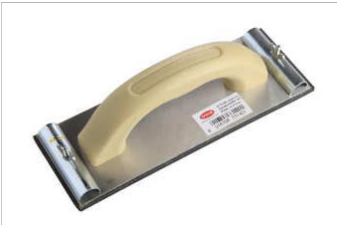
Handschleifer mit Bügelgriff, Aluminium-Grundplatte Handgriff aus geschäumtem Kunststoff, aufgeklebte Zellkautschuk- Platte, 2 Metall-Klemmbacken, für alle gängigen Schleifpapiere. Speziell zum Schleifen von Rigips-Wänden mit Gitterschleiflein. Nr. 5173140 235 x 80 mm
