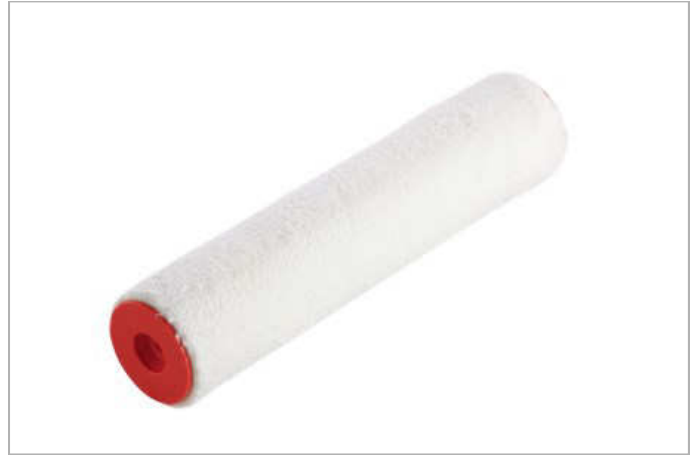
Lackierwalze "Microfiber weiß", ungepolstert Florhöhe 4 mm, 48 cm Rollendurchmesser, für die Anwendung von wasserbasierenden Lacken Nr. 5179840 20 cm Nr. 5179845 25 cm
