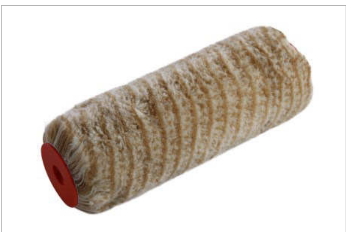
Malerwalze "DUX", ungepolstert 100 % Polyamid, Florhöhe 21 mm, bestens geeignet für Dispersions-, und Silikatfarben im Innen- und Außenbereich Nr. 5179570 20 cm Nr. 5179575 25 cm
