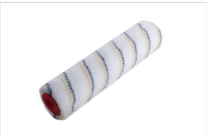
Lackier- und Beschichtungswalze "Nylon gelb/schwarz", ungepolstert 100 % Polyamid, Florhöhe 7 mm, geeignet für Versiegelungen, Öl-, Lack- und Kunstharzfarben sowie Rostschutzanstriche Nr. 5170236 18 cm Nr. 5170238 25 cm
