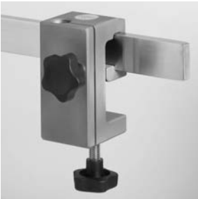
19799-04 Leichtmetall-Klemmsockel Spannweite 50 mm, für ein höhenverstellbares Stativ Ø 16 mm, für Schienen 25/35 x 8/10 und Rohre Ø 12 - 35 mm. Clamp socket made of light metal, holding width 50 mm, for height-adjustable stand Ø 16 mm, for rails 25/35 x 8/10 and tubes Ø 12 - 35 mm.
