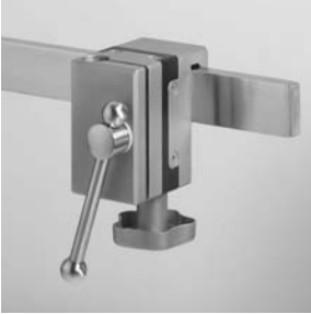
19799-01 Klemmsockel aus rostfreiem Stahl, für ein höhenverstellbares Stativ Ø 16 mm, elektrisch isoliert bis 1,5 kV AC, Spannweite 35 mm für Schienen 25/32 x 8/12 mm. Clamp socket made of stainless steel, for height-adjustable stand Ø 16 mm, electrically insulated up to 1.5 kV AC, holding width of 35 mm for rails 25/32 x 8/12 mm.
