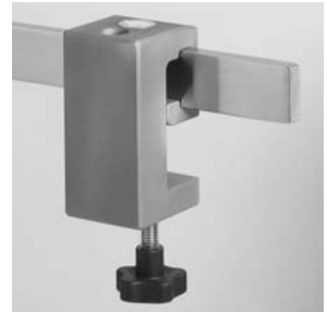
19799-06 Leichtmetall-Klemmsockel Spannweite 50 mm, für ein Schraubstativ mit Ø 16 mm/M10, für Schienen 25/35 x 8/10 und Rohre Ø 12 - 35 mm. Clamp socket made of light metal, holding width 50 mm, for screw stand Ø 16 mm/M10, for rails 25/35 x 8/10 and tubes Ø 12 - 35 mm.
