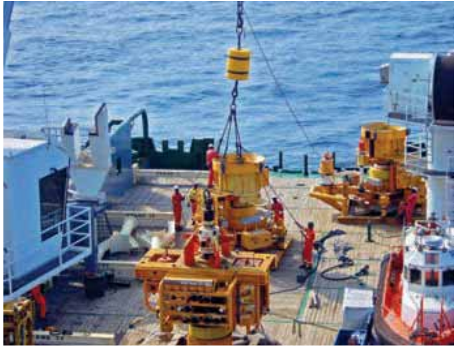
> Ci-dessus Préparation de mise à l'eau d'un colis subsea (Xmas tree et tête de puits).
