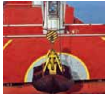
> Début des opérations de déchargement du charbon par des bennes « Peina » de 13 m 3 à bord du Shangor.
