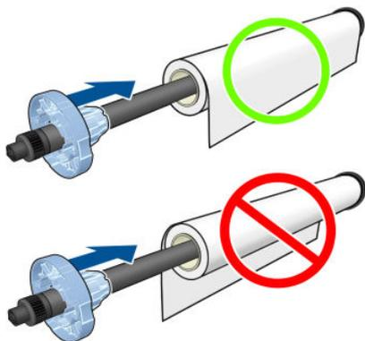
Beide Enden der Rolle müssen sich möglichst nahe an den Spindelanschlüssen befinden.
