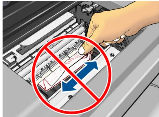
**⚠ ACHTUNG:** Verschieben Sie das Druckmaterial nicht seitwärts, da der Drucker sonst beschädigt werden könnte.
