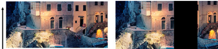
Vorlage und von ausgefallenem Scanbalken betroffener Scan
