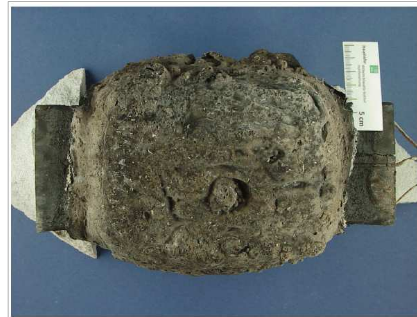
Aufgeschäumte Brandschutzbeschichtung nach einem Brandversuch an einem Stützenabschnitt
