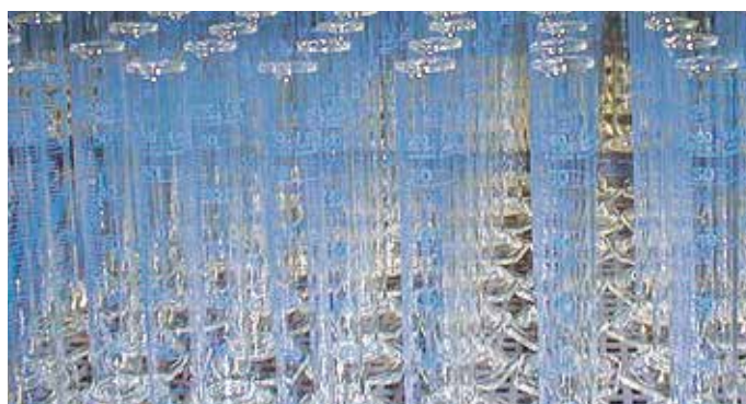
Probetas graduadas con impresión, antes de la fusión
