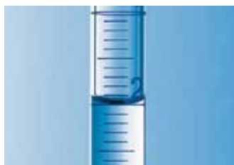
Menisco cóncavo en una pipeta graduada.
