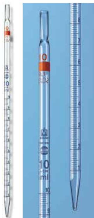
pipeta graduada tipo 2, volumen nominal arriba
