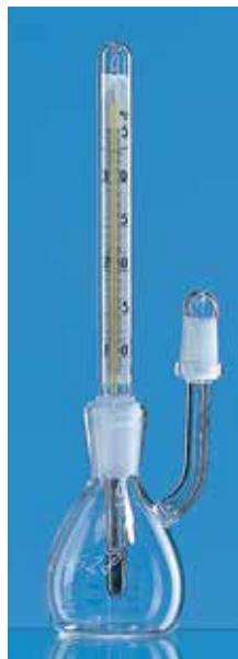
Picnómetro con termómetro y capilar lateral (recomendada para líquidos con presión de vapor más alta)
