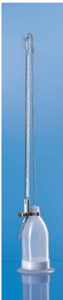
Bureta de cero automático según Dr. Schilling
