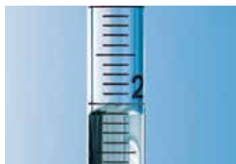
Menisco convexo en una pipeta graduada.
