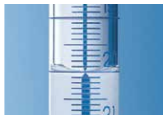
Figura de menisco en un aparato volumétrico con franja de Schellbach, como por ej. una bureta.
