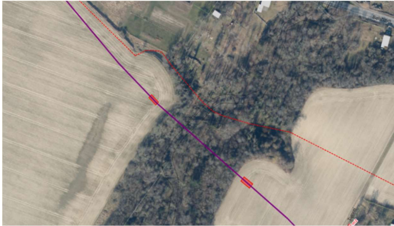
Figur 2: De røde firkanter viser, hvor opgravningen foretages ifm. den styrede underboring (kilde: BEOF).
