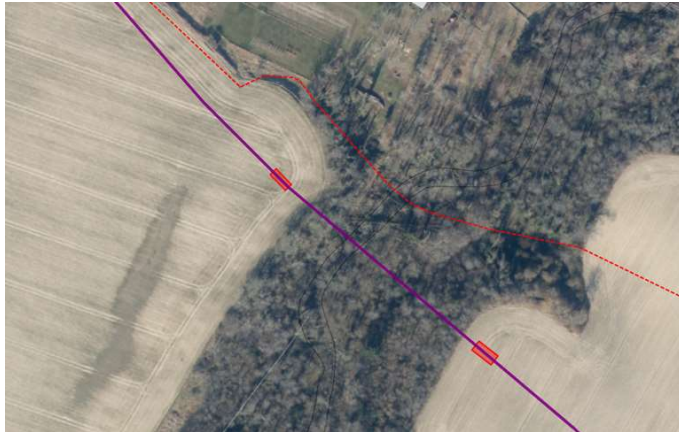
Figur 7: Luftfoto fra ansøgningen, hvor traceet for spildevandsledningen er vist. De styrede underboring sker mellem de to røde firkanter, og der underbores således under hele Natura 2000-området (kilde: BEOF).
