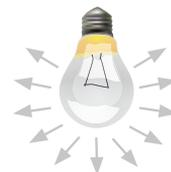
Der Lichtstrom bezeichnet die von einer Lichtquelle gesamt Strahlungsleistung, unabhängig von der Ausstrahlung. Er wird in der Einheit Lumen angegeben.
