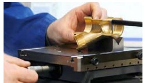
Prüfung mittels Konturograph
