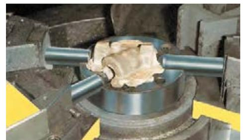
Minimierung des Einsatzgewichtes durch das Hohlpressverfahren
