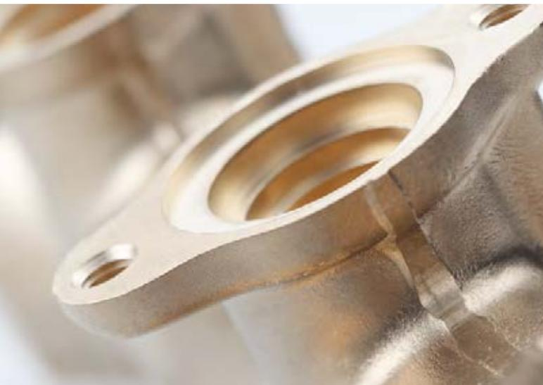
Durch Gesenkschmieden (Warmpressen) in unserer Warmpresserei werden bei auf den Werkstoff angepassten Schmiedetemperaturen Voll- und Hohlpressteile bis zu einem Stückgewicht von ca. 5.000 g hergestellt. Verarbeitet werden unterschiedliche Kupfer-Zink-Legierungen (Messing), entzinkungsarme sowie moderne, bleifreie Messinglegierungen nach DIN 50930-6.
