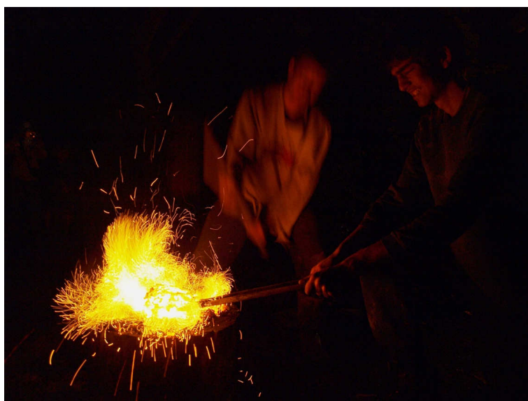
6. ábra: A vasbuca tömörítése
