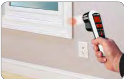
Rote LED-Anzeige: Hier ist es wärmer.
