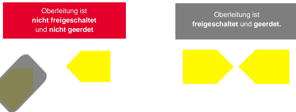
Abbildung 60 – Schaltzeiger des Ladegleisschalters - neu
