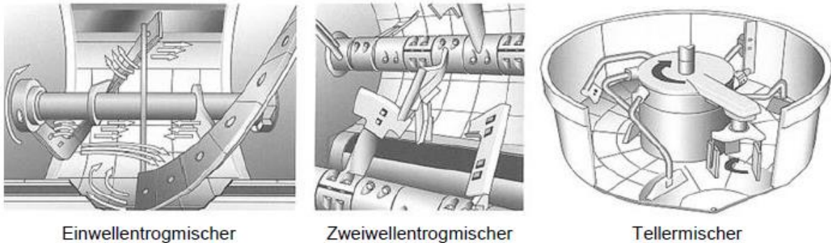
Abbildung 3: Mischertypen in der Transportbetonindustrie
