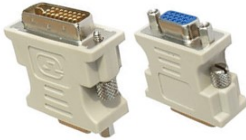
Abbildung 147: DVI- und VGA-Schnittstelle
