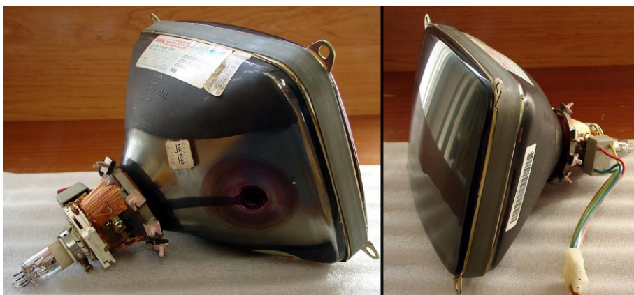
Abbildung 38: 9"-Schwarz-Weiß-Bildröhre mit zugehöriger Ablenkeinheit (Wikimedia Commons)
