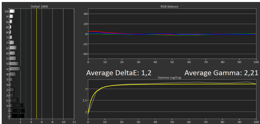
Abbildung 448: DeltaE- und RGB-Balance-Analyse - Teil der BUROSCH-Bild-Kalibrierung
