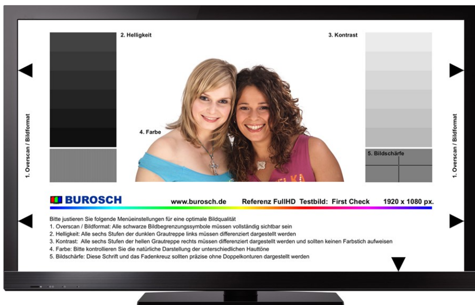
Abbildung 481: Universal-Testbild „First Check“ mit fünf Testzonen
