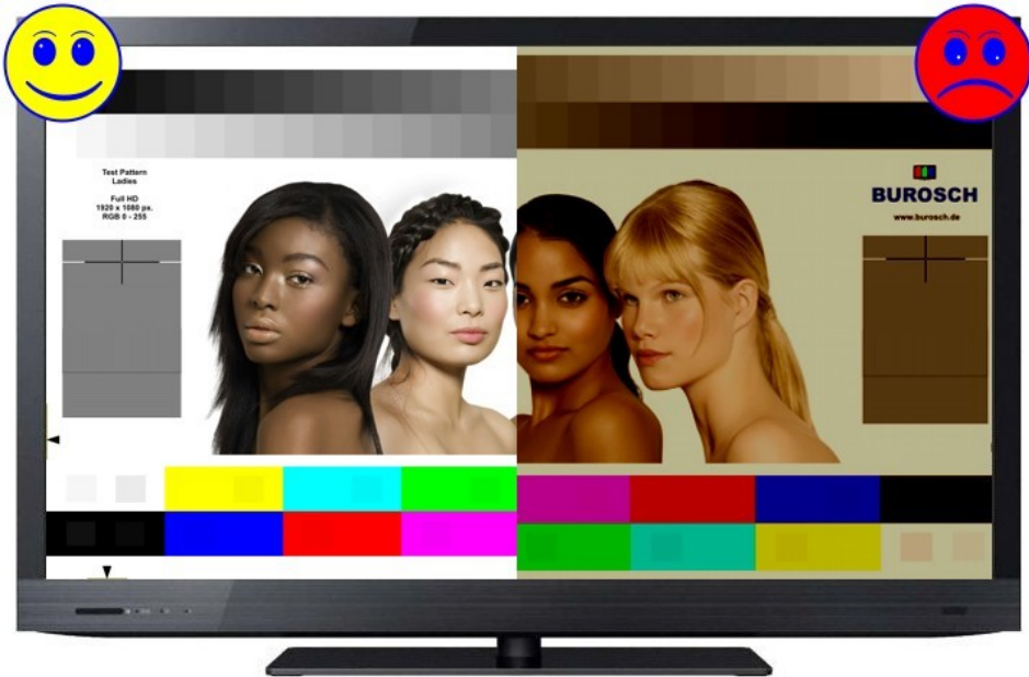
Abbildung 469: Beispiel für richtige (links) und falsche (rechts) Bildwiedergabe im Universal-Testbild „Ladies Vs.1“ von BUROSCH
