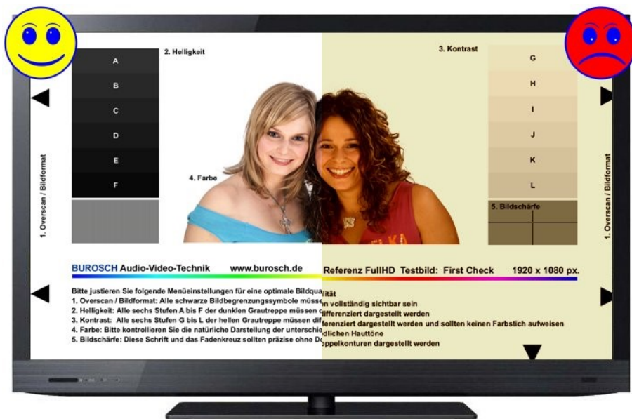
Abbildung 439: BUROSCH-Testbild „First Check“: schnelle Bildeinstellung aller TVs und Beamer
