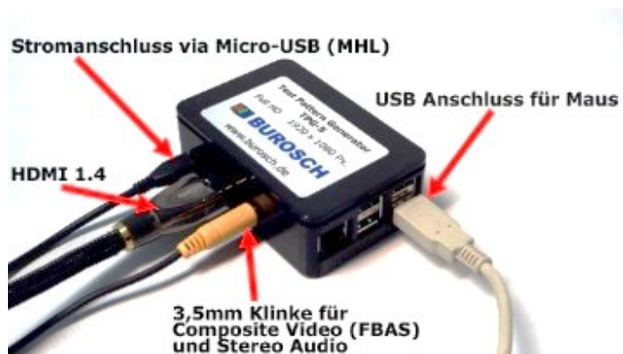
Abbildung 95: Full-HD-Testbildgenerator TPG-5 der Firma BUROSCH
