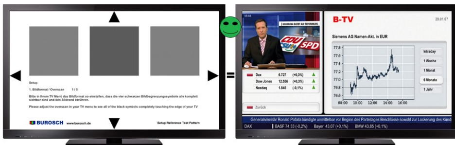
Abbildung 456: BUROSCH Basic-Testbild Nr. 1: Bildformat/Overscan plus Realbild
