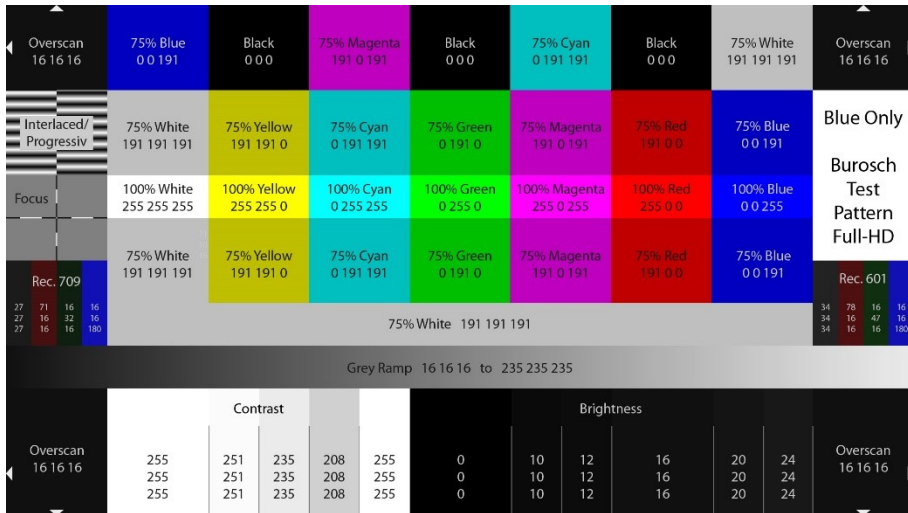
Abbildung 446: BUROSCH Blue-Only Test-Pattern inklusive Erklärung (Wikimedia Commons)
