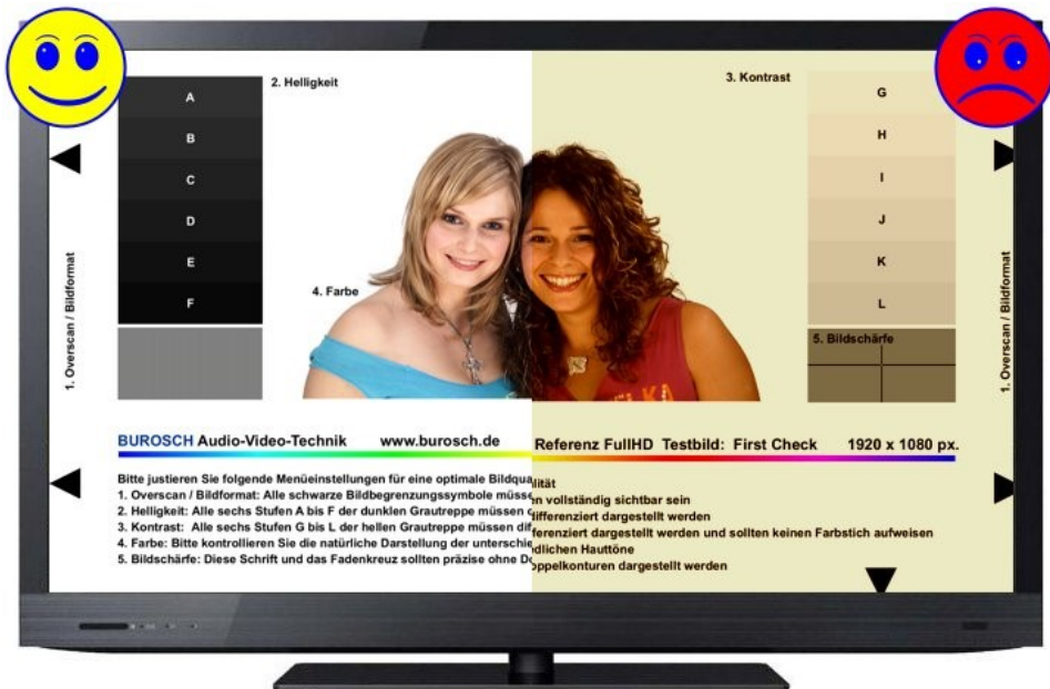
Abbildung 468: Beispiel für richtige (links) und falsche (rechts) Bildwiedergabe im Universal-Testbild „First Check“ von BUROSCH
