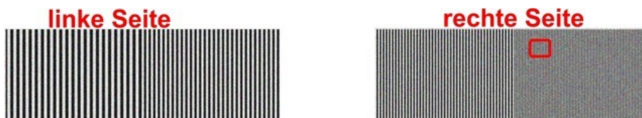
Abbildung 117: Detailansicht des Multiburst-Streifenmusters/hier: „mangelhaft“
