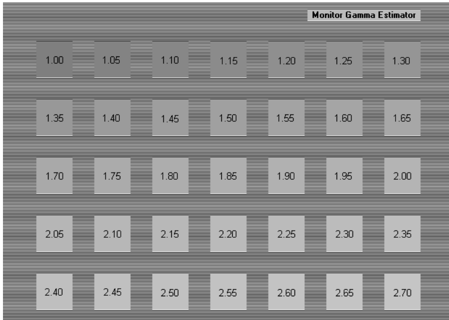
Abbildung 54: Grafik zur Bestimmung des Gammawerts im Selbsttest
