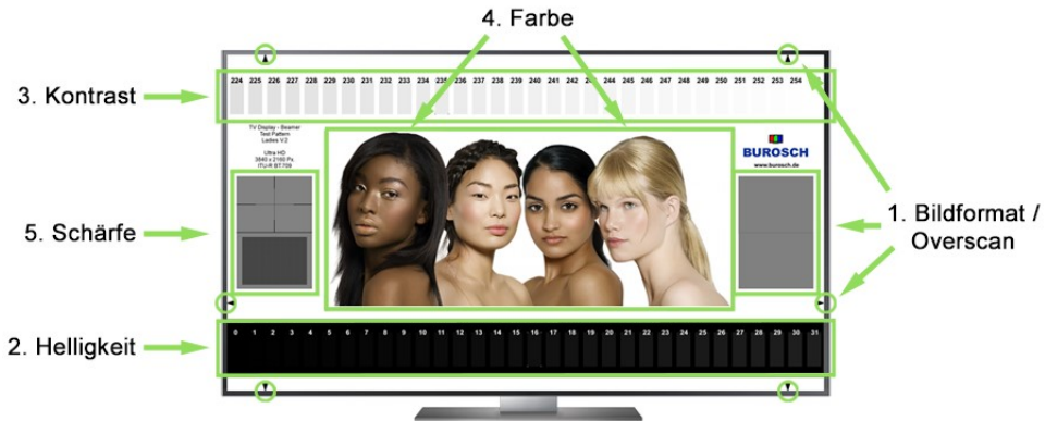
Abbildung 470: Universal-Testbild „Ladies“ Vs. 2 für die schnelle Optimierung der Grundeinstellungen
