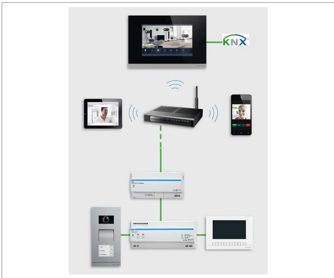
Abb. 68: Türsprechanlage mit IP-Gateway und mobilen Endgeräten
