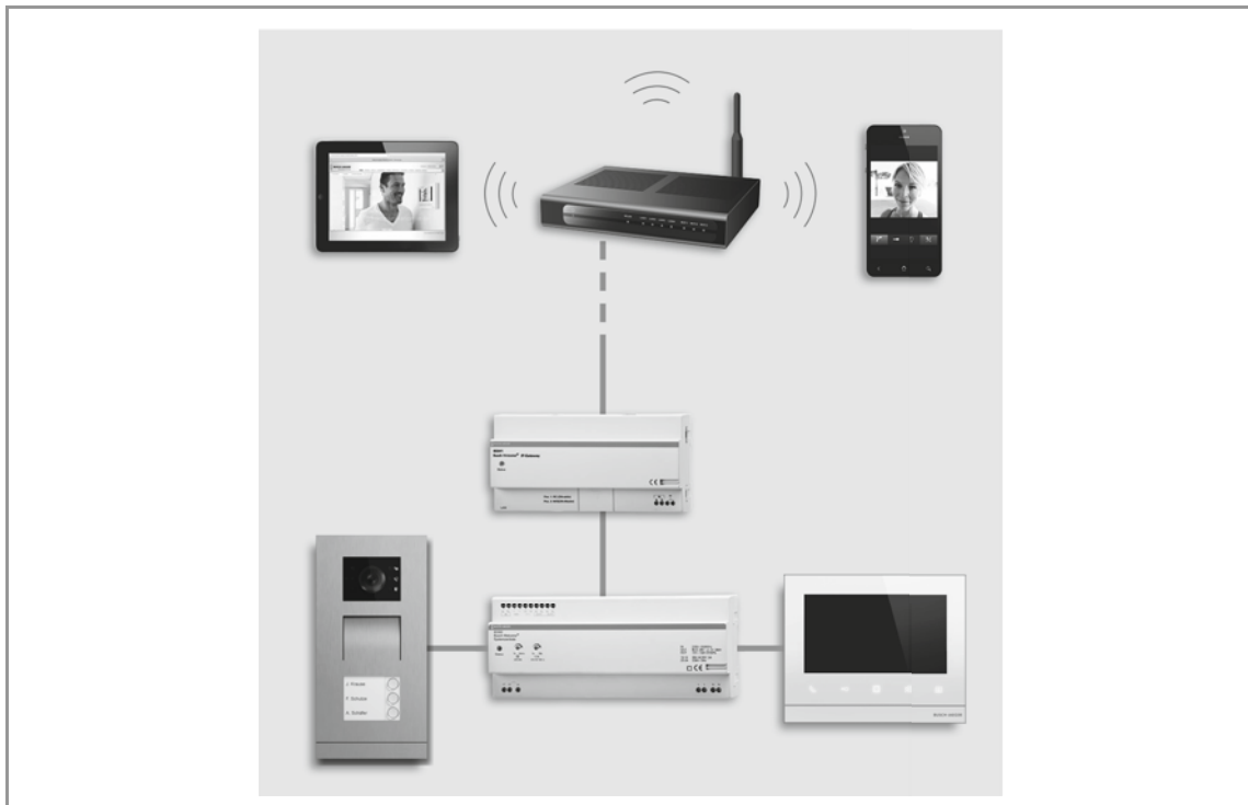
Abb. 72: Türsprechanlage mit IP-Gateway und mobilen Endgeräten
