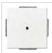
Zentralscheibe 1) mit Leitungsauslass Als Abdeckung für Leitungsauslass. Mit Zugentlastung (ohne Anschlussklemmenblock). Schutzart Gerät: IP 20
