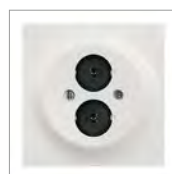
Zentralscheibe mit Tragring Mit Spreizbefestigung Mit 2 Lautsprecher-Steckverbindern. Mit Lötanschluss. Zur Abdeckung nach DIN 41524, 41529, 45322, 45327, 45328 und 45329 von Kleinsteckdosen und Rundsteckverbinder mit Schraubverschluss M 16x0,75 (einbaubar in Sockeleinsatz). Schutzart Gerät: IP 20
