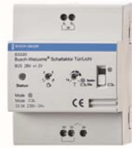
Schaltaktor Tür/Licht, Artikel-Nr. 83330 Zum Anschluss eines elektrischen Türöffners oder zum Schalten des Lichtes bzw. zum Anschluss eines Lichtrelais (potentialfreier Ausgang 230 V, 3 A).
