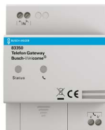
Telefon-Gateway, Artikel-Nr. 83350 Zum Anschluss einer Busch-Welcome® Anlage an die analogen Eingänge einer vorhandenen Telefonanlage. Ermöglicht die Nutzung eines Telefones (z.B. DECT, ISDN, Mobiltelefon) als Türkommunikations-Innenstation.
