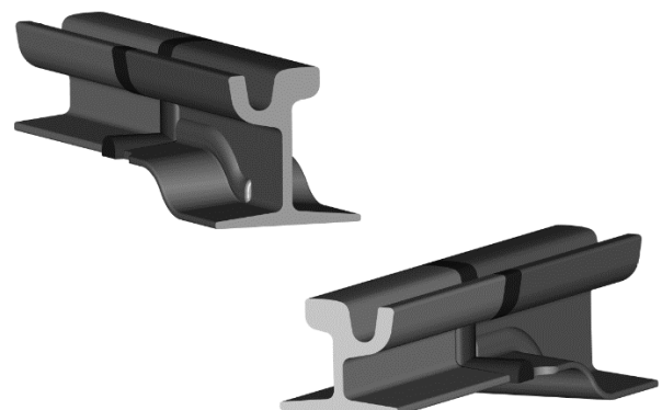
Abb. 26-3: Schweisstoss mit Profilstauchung
