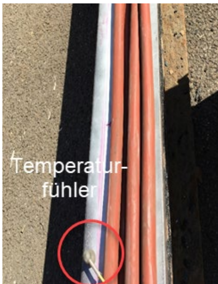
Abb. 20-1: Temperatursensor auf Fahrkopf
