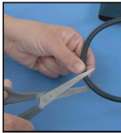
Sectionnement du tuyau
