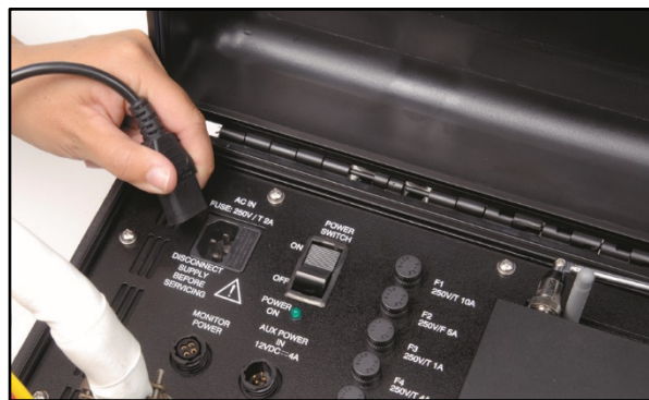
Raccordement du cordon d'alimentation au bloc A/C
