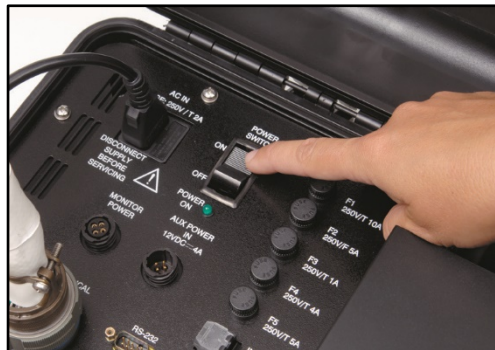
Mise sous tension du bloc A/C
