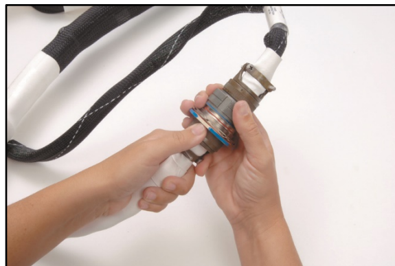
Serrez le raccord
