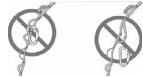
Fig. 6: uso errato della Daisy chain
