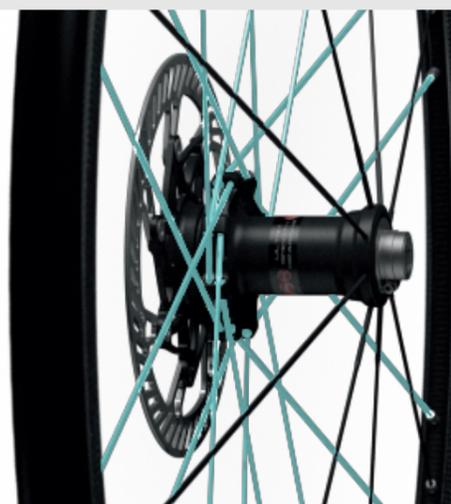
Geänderte Ausführung des bekannten G3™-Einspeichsystems für das vordere Laufrad
