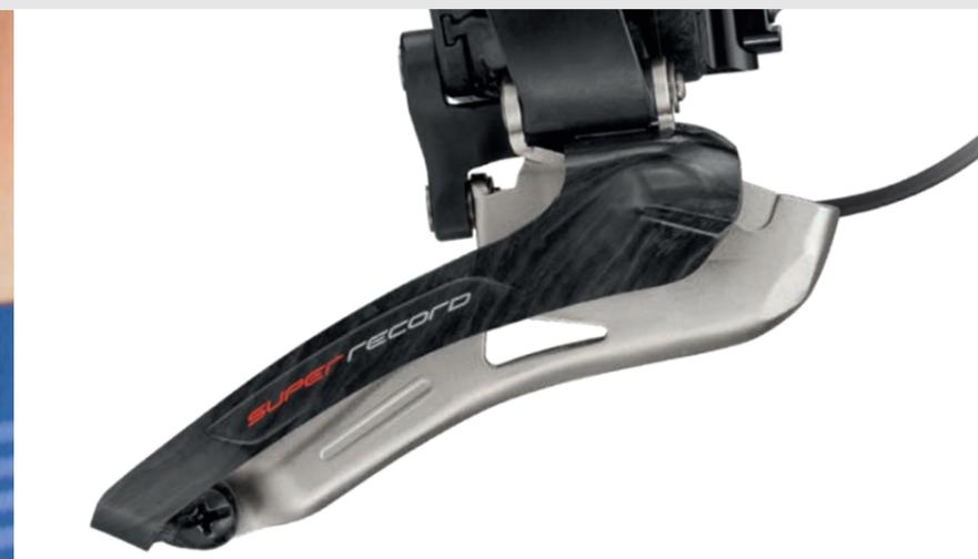
Das innere Leitblech des Umwerfers und das große 12 Speed Kettenrad wurden optimal aufeinander abgestimmt
