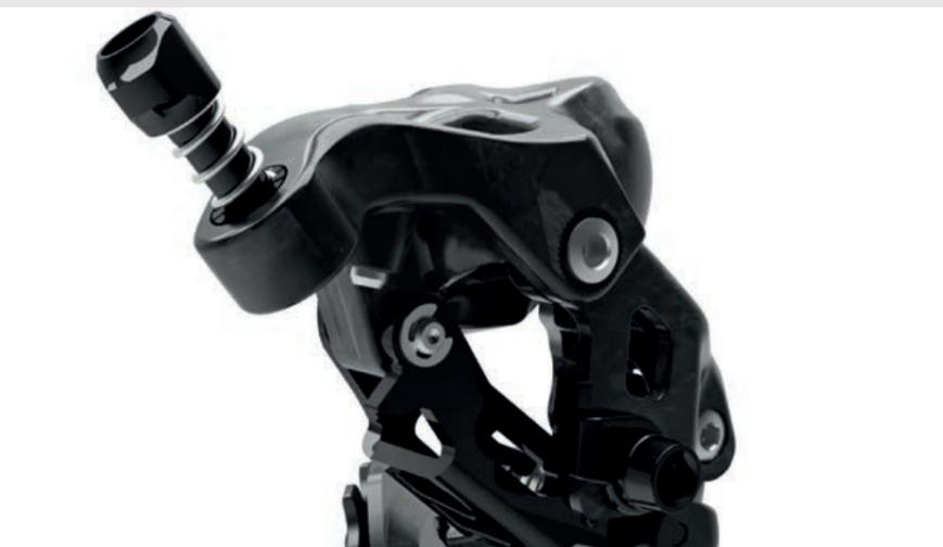
Anschlagschraube auf der Rückseite des oberen Gehäuseteils
