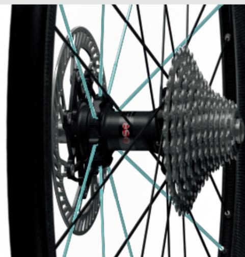
Geänderte Ausführung des bekannten G3™-Einspeichsystems für das hintere Laufrad
