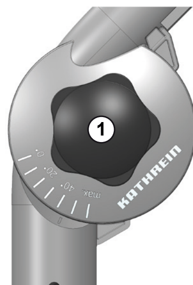
Abb. 7: Sterngriffschraube am Adaptergelenk
