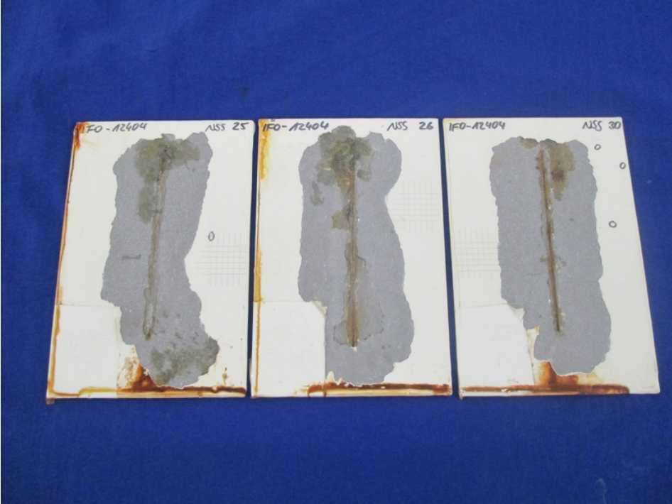
Abbildung 3 – Proben nach 720 Stunden NSS-Prüfung
