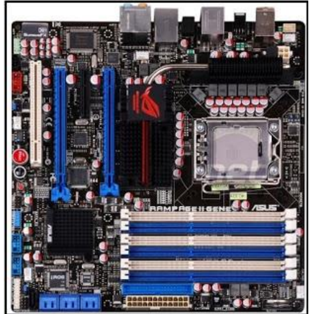
↑ Esquema del factor de forma Micro-ATX.
