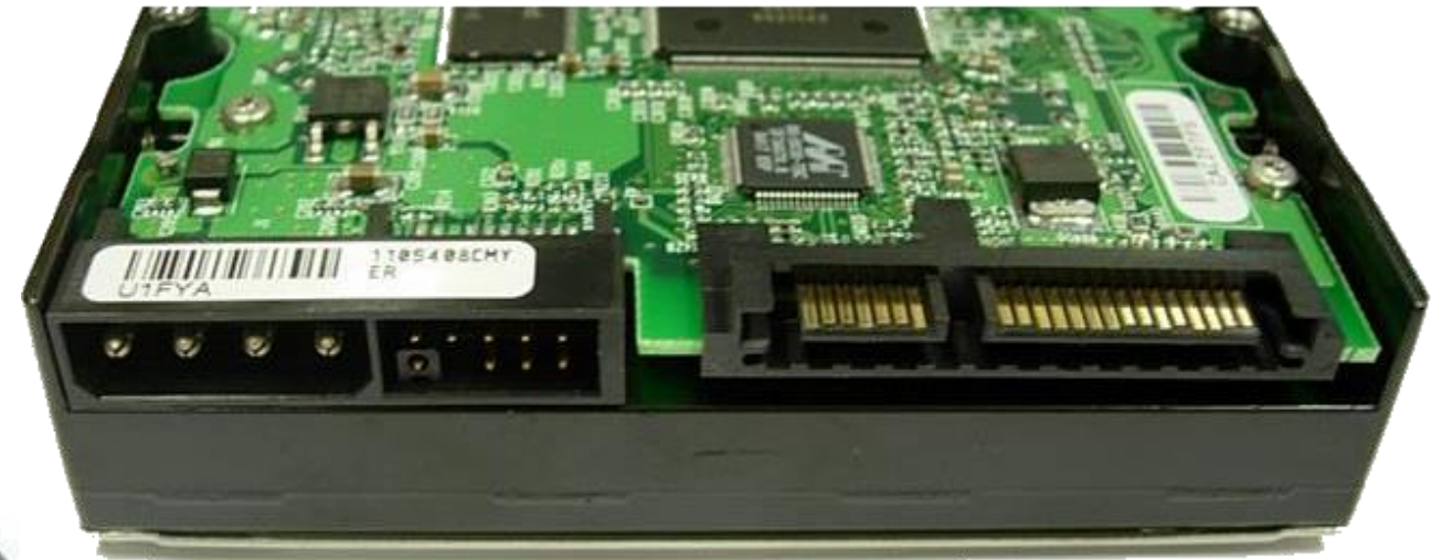
Disco duro SATA con conectores de alimentación SATA e IDE (PATA)
