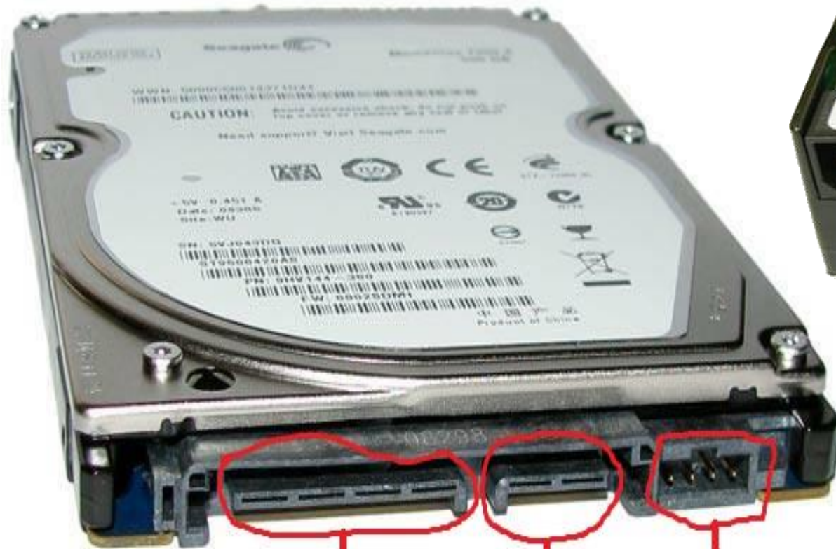
Disco duro SATA con conectores de alimentación SATA e IDE (PATA)
