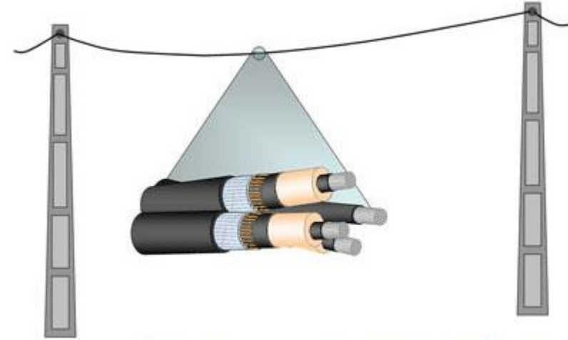
Los cables trenzados para MT se utilizan en redes tensadas
