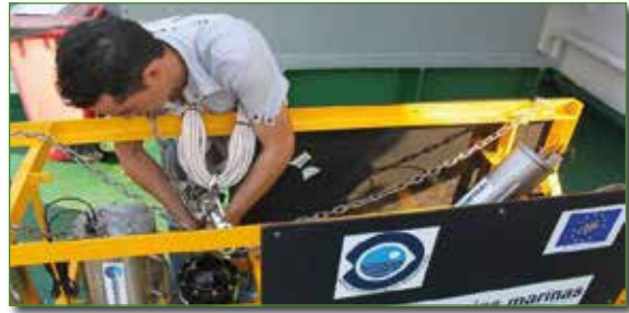
Figura 3.10. VOR (Vehículo de Observación Remolcado): es un sistema de observación submarina no tripulado y sin posibilidad de interactuar con el fondo marino. Consiste en una estructura de acero en la que se acoplan varios focos de iluminación, una cámara fotográfica HD y otra de video Full-HD, con el fin de obtener imágenes digitales de muy alta resolución de la superficie del fondo marino. Fotos: IEO/GEMAR.
