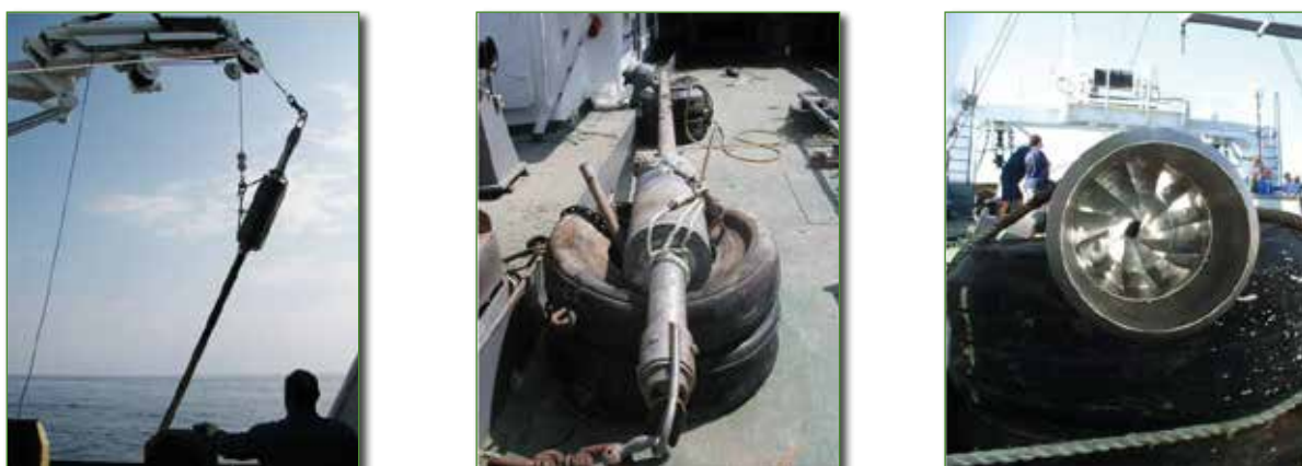
3) Sacatestigos de gravedad: consiste en un cuerpo muy pesado al que se le une una lanza cilíndrica cerrada con una pieza metálica de mayor dureza. El sistema se lanza sobre el fondo en caída libre. Una vez a bordo, se extrae el material y se corta en secciones.
