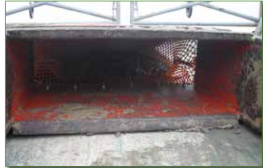
Figura 3.12. Draga de arrastre bentónico: funciona como un “patín” deslizándose sobre el fondo, recolectando flora y fauna que queda retenida en la malla, la cual está protegida con gruesos cueros. Las imágenes muestran diferentes momentos de la maniobra de arriado y virada. Fotos: IEO/GEMAR.
