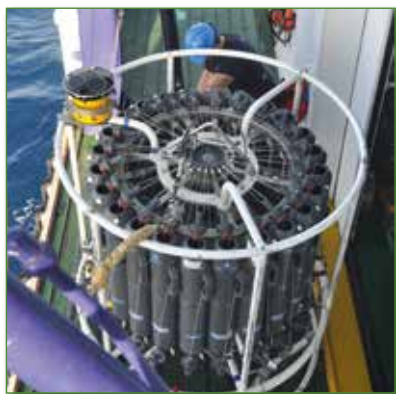
Figura 3.9. Equipos de muestreo de oceanografía física: (izquierda) ADCP instalado en roseta oceanográfica; (derecha) CTD. Fotos: IEO/GEMAR.
