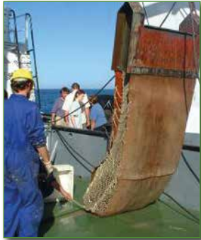
Figura 3.12. Draga de arrastre bentónico: funciona como un “patín” deslizándose sobre el fondo, recolectando flora y fauna que queda retenida en la malla, la cual está protegida con gruesos cueros. Las imágenes muestran diferentes momentos de la maniobra de arriado y virada. Fotos: IEO/GEMAR.
