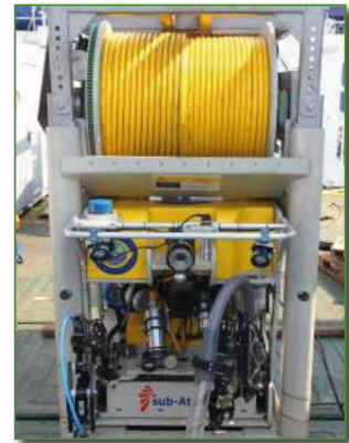
Figura 3.10. VOR (Vehículo de Observación Remolcado): es un sistema de observación submarina no tripulado y sin posibilidad de interactuar con el fondo marino. Consiste en una estructura de acero en la que se acoplan varios focos de iluminación, una cámara fotográfica HD y otra de video Full-HD, con el fin de obtener imágenes digitales de muy alta resolución de la superficie del fondo marino. Fotos: IEO/GEMAR.
