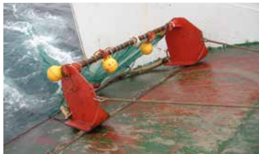
Figura 3.13. Beam-trawl (o bou de vara): se trata de un arte de arrastre usado para fondos blandos. Funciona como un “patín” deslizándose sobre el fondo, recolectando flora y fauna que queda retenida en la malla y el copo. Es muy eficaz en el muestreo de los organismos que viven sobre el sustrato (epibentos). Las imágenes muestran diferentes momentos de la maniobra de arriado y virada. Fotos: IEO/GEMAR.
