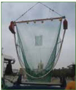
Figura 3.13. Beam-trawl (o bou de vara): se trata de un arte de arrastre usado para fondos blandos. Funciona como un “patín” deslizándose sobre el fondo, recolectando flora y fauna que queda retenida en la malla y el copo. Es muy eficaz en el muestreo de los organismos que viven sobre el sustrato (epibentos). Las imágenes muestran diferentes momentos de la maniobra de arriado y virada. Fotos: IEO/GEMAR.
