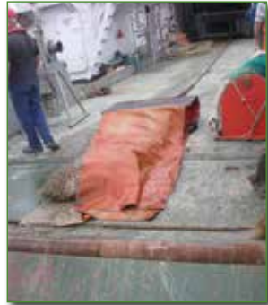
Figura 3.12. Draga de arrastre bentónico: funciona como un “patín” deslizándose sobre el fondo, recolectando flora y fauna que queda retenida en la malla, la cual está protegida con gruesos cueros. Las imágenes muestran diferentes momentos de la maniobra de arriado y virada. Fotos: IEO/GEMAR.
