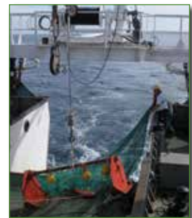
Figura 3.13. Beam-trawl (o bou de vara): se trata de un arte de arrastre usado para fondos blandos. Funciona como un “patín” deslizándose sobre el fondo, recolectando flora y fauna que queda retenida en la malla y el copo. Es muy eficaz en el muestreo de los organismos que viven sobre el sustrato (epibentos). Las imágenes muestran diferentes momentos de la maniobra de arriado y virada. Fotos: IEO/GEMAR.
