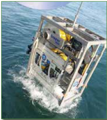
Figura 3.10. VOR (Vehículo de Observación Remolcado): es un sistema de observación submarina no tripulado y sin posibilidad de interactuar con el fondo marino. Consiste en una estructura de acero en la que se acoplan varios focos de iluminación, una cámara fotográfica HD y otra de video Full-HD, con el fin de obtener imágenes digitales de muy alta resolución de la superficie del fondo marino. Fotos: IEO/GEMAR.
