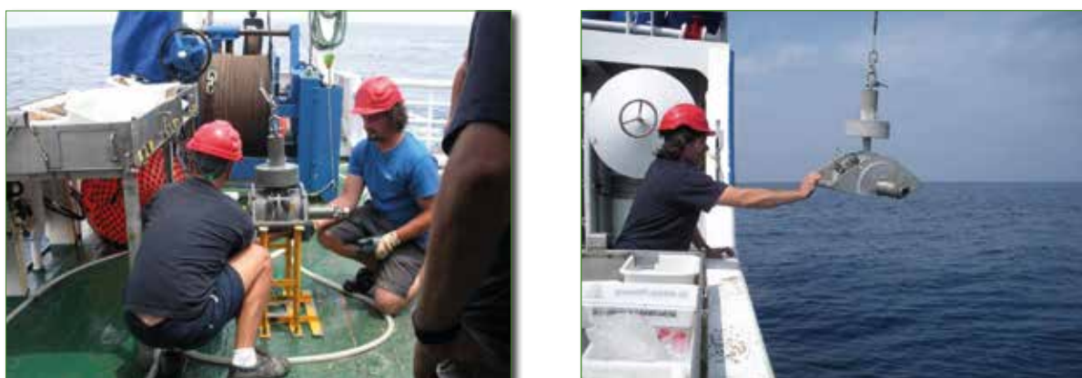
2) Draga Shipek: consiste en un cuerpo rígido y pesado que se acciona por colisión contra el fondo cuando se deja en caída libre. En ese momento, una cazoleta gira súbitamente y recoge el sedimento que se encuentra bajo la draga. Fotos: IEO/GEMAR.
