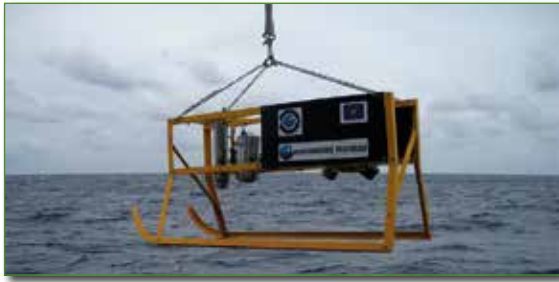
Figura 3.10. VOR (Vehículo de Observación Remolcado): es un sistema de observación submarina no tripulado y sin posibilidad de interactuar con el fondo marino. Consiste en una estructura de acero en la que se acoplan varios focos de iluminación, una cámara fotográfica HD y otra de video Full-HD, con el fin de obtener imágenes digitales de muy alta resolución de la superficie del fondo marino. Fotos: IEO/GEMAR.
