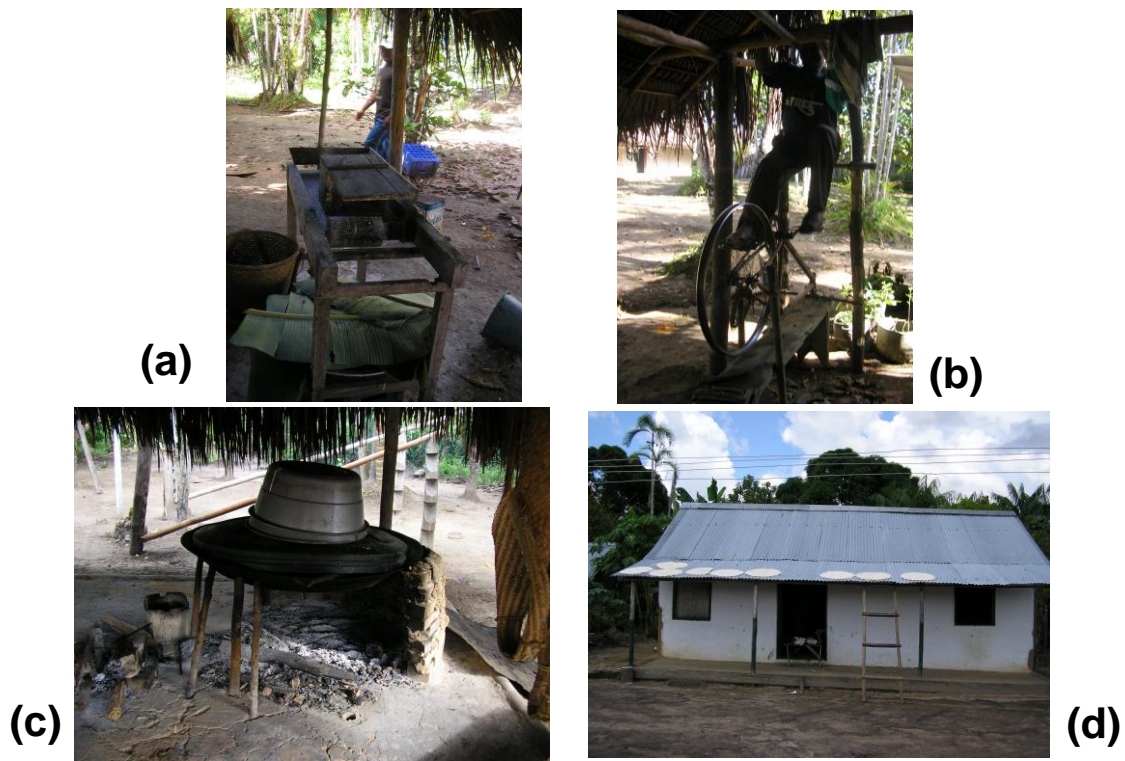
Figura 35. Ejemplos de elementos tradicionales y modernos (a) Rayador de Yuca; (b) Tecnología traída de afuera: impulsor para el rayador; (c) Budare para tostar; (d) Un uso de la teja de zinc: secado de las tortas de cazabe.
