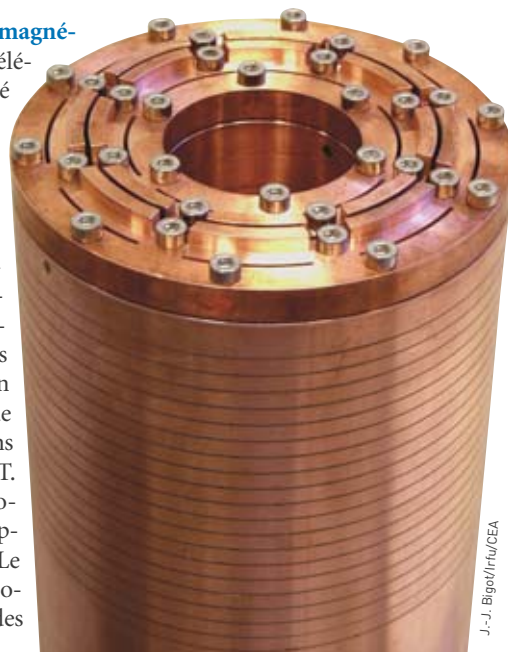
Prototypes de bobines de gradient de champ magnétique pour l'IRM destinées à atténuer les problèmes de fatigue mécanique et les effets acoustiques. L'un des défis technologiques sera de limiter le bruit à 140 dB pour l'IRM de 11,7 T.
