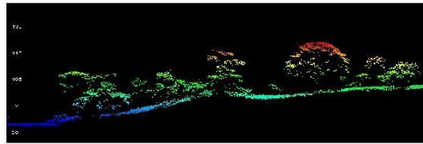
Fig. 3. Profil altimétrique des données brutes Lidar (coloration des points en fonction de l'élévation). Site DARTM de Coconi.
