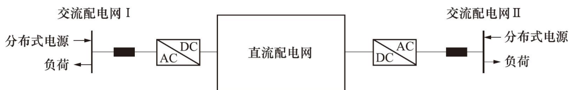
图 B.3 交直流互联 AC-DC-AC 拓扑示意图
