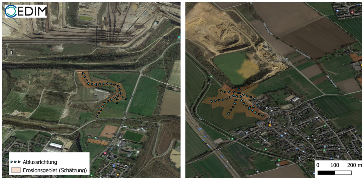
Abbildung 21: Geschätztes Erosionsgebiet im Bereich der Inde (links) und Blessem (rechts). Zusätzlich ist die grobe Abflussrichtung eingetragen.
