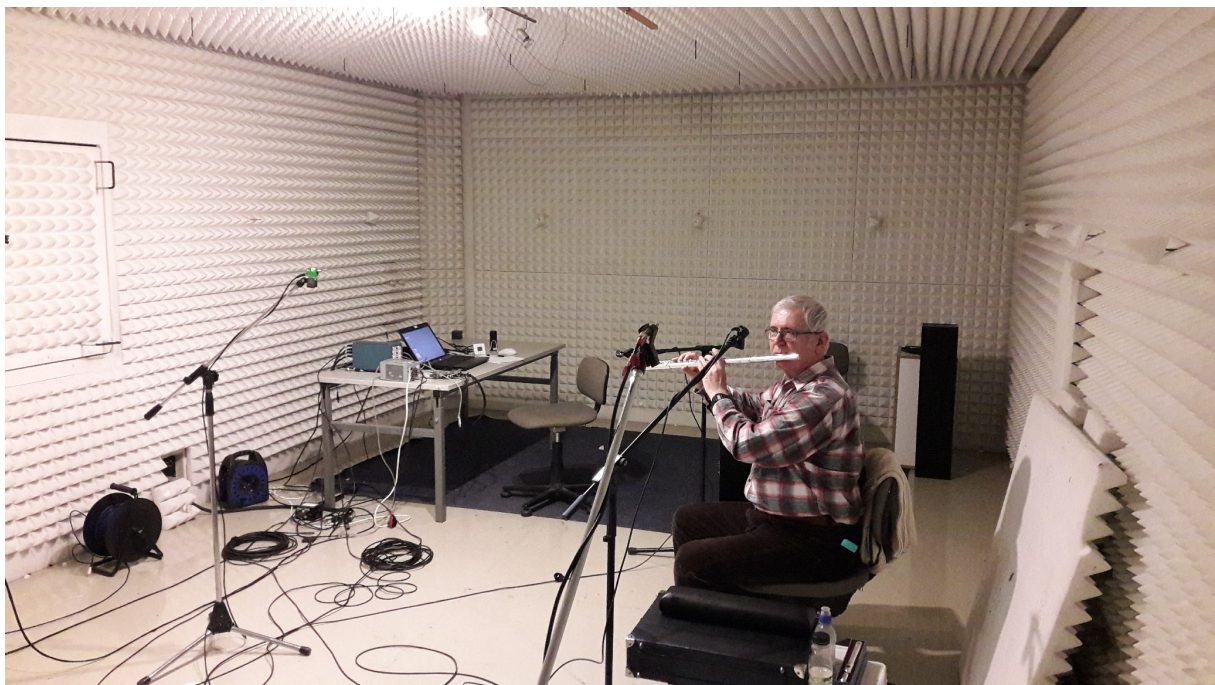
1. ábra. Mérési összeállítás a félszabad hangterű mérőhelyiségben
