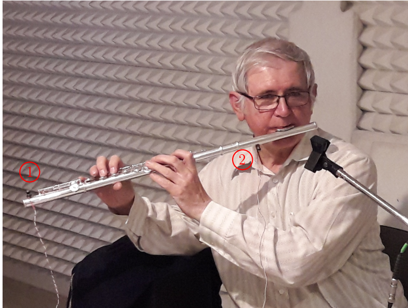
2. ábra. Rezgésérzékelők elhelyezése a fuvolán
